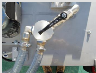
Ingresso a due vie acqua torbida
