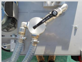
Ingresso a due vie acqua torbida
